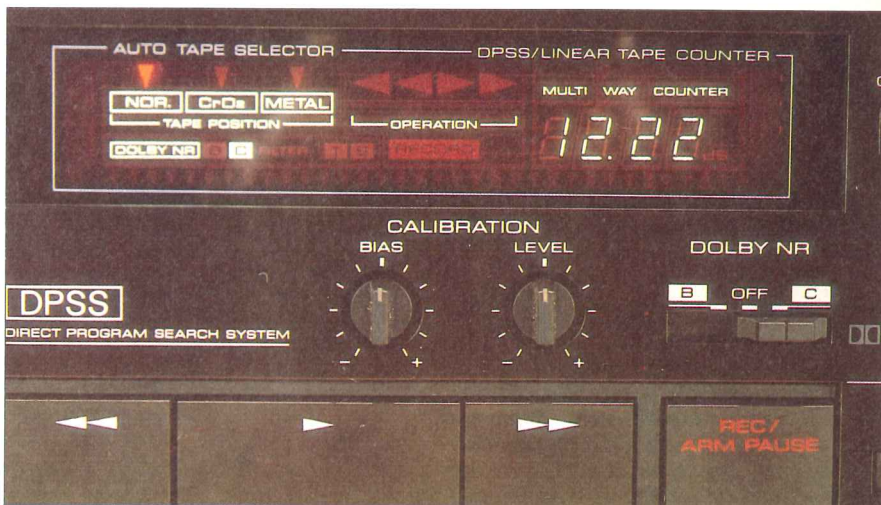
Il contatore fornisce con ottima precisione il tempo effettivo, in minuti e secondi.
